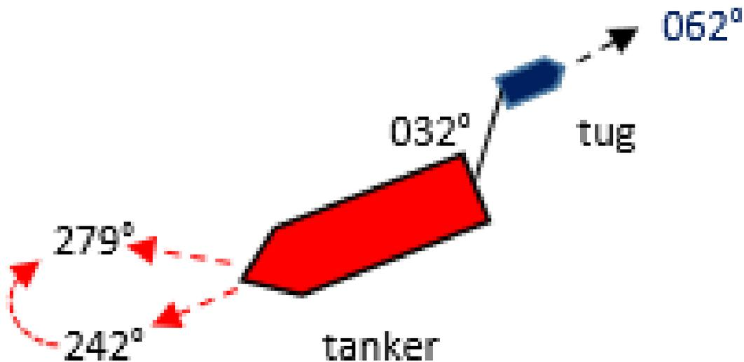
Рис. 1. Буксирная линия имела направление 32° (указывала на 5 часов относительно курса танкера). Диаметральная плоскость буксира была параллельна диаметральной плоскости танкера. Буксирный трос скользнул по планширу к рубке, в результате чего буксир накренился на правый борт, и в это время на него обрушилась первая волна.
